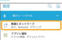
3 次に「Wi-Fi」をタップして、表示されたワイヤレスネットワークの一覧から、接続するネットワークSSIDをタップします。本製品のネットワークSSIDは、本製品の側面にあるラベルに記載されている「SSID」をご確認ください。
